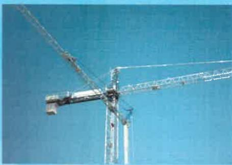
GRU AUTOMONTANTI IDRAULICHE CON ROTAZIONE IN BASSO
